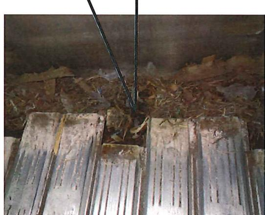
※床板のストローク量を確保出来ず途中停止の原因になります。
