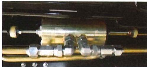
④ボールバルブ：作動油の流れを切り替えてウォーキングフロアーを
